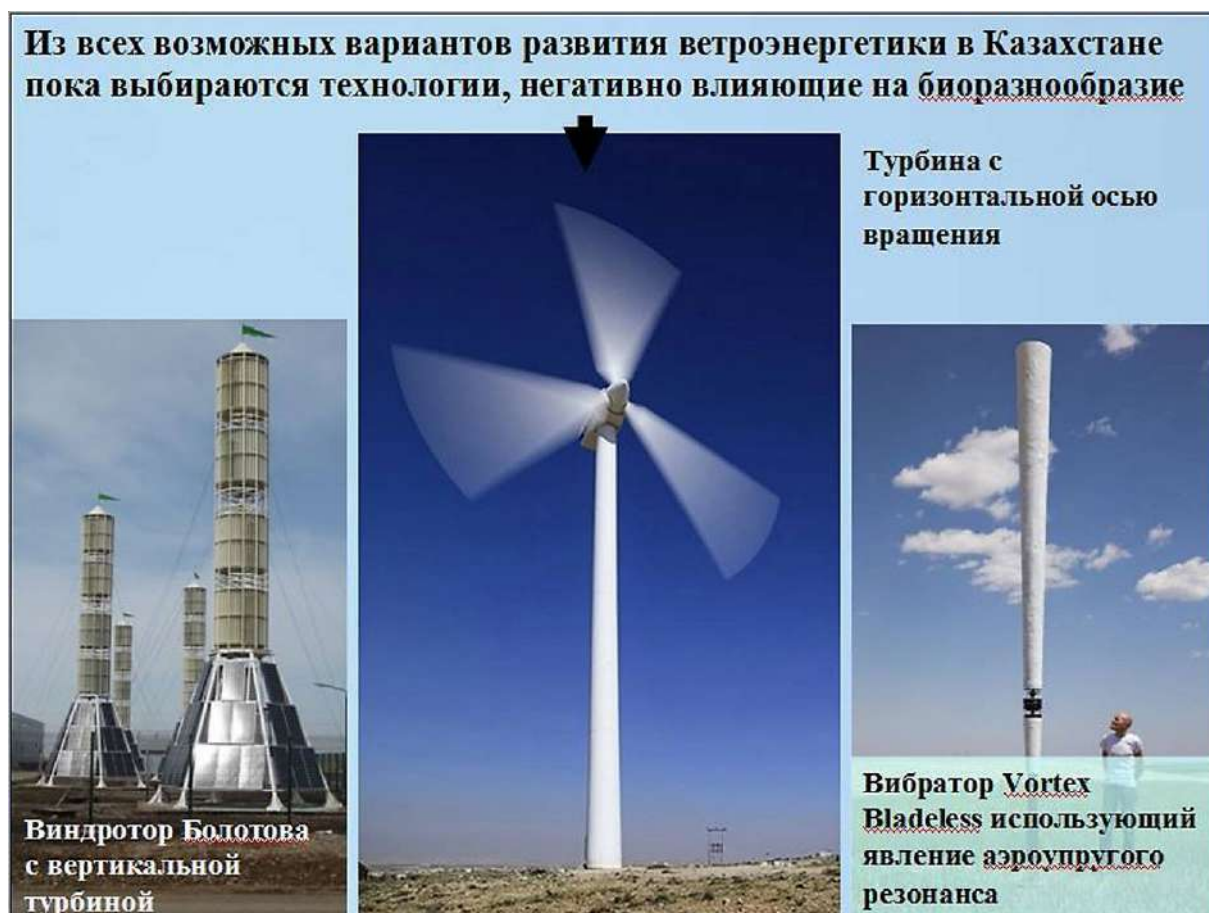
Рис. 3. Опасными для птиц являются ветрогенераторы с горизонтальной осью. Именно такие технологии активно внедряются на всей территории Центральной Азии. Однако это не единственный доступный вариант.
